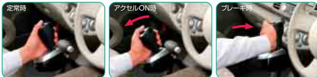
バームレスト(台座)に手をおけるので長時間走行も快適です。 手の動きだけでアクセル操作ができます。 前方に押しつけてブレーキ。
