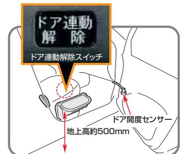
フラップシートを使用しない時は、ドア連動解除スイッチを押すと格納状態にすることが可能です。ドア開度センサーがドアの開閉を感知して、電動でフラップシートが開閉します。
