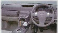
●「オーテックドライブギア タイプe」 運転する愉しさを追求した、新開発の手動運転装置 「オーテックドライブギア タイプe」登場。 ステージア "ドライビングヘルパー" は お体の不自由な方が運転するための手動運転装置装着車です。
