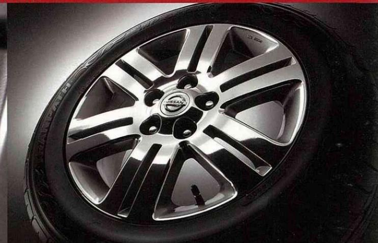
専用16インチ光輝アルミロードホイール (16X6.5JJ) & 専用215/55R16 91Vタイヤ
